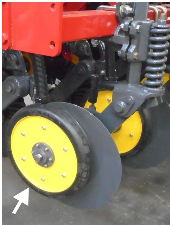
*Figura 25: Ruedas reguladoras de profundidad fertilizante*
