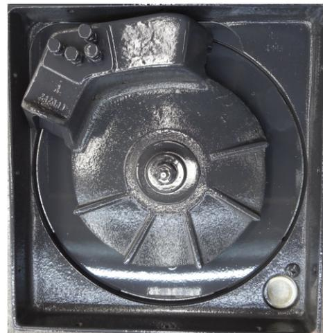
Si ha desarmado el cabezal de siembra, tenga cuidado que al armarlo, el pico de fijación: **A** **Figura 39** se inserte debidamente en su alojamiento.
