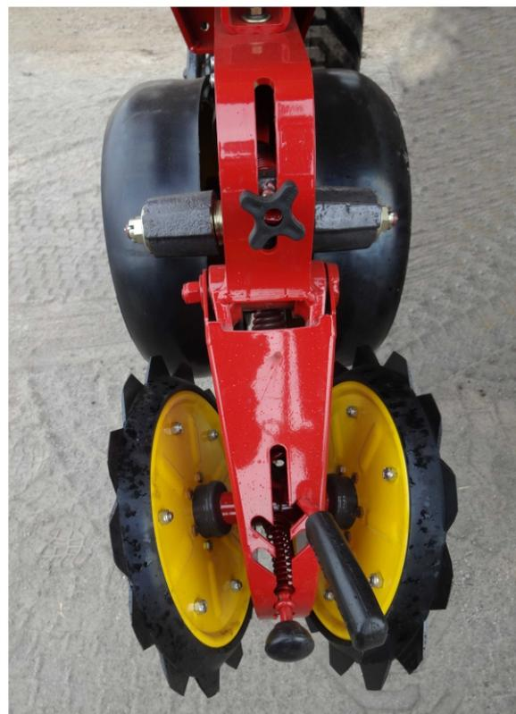
Figura 6: Brazo de ruedas reguladoras de profundidad
