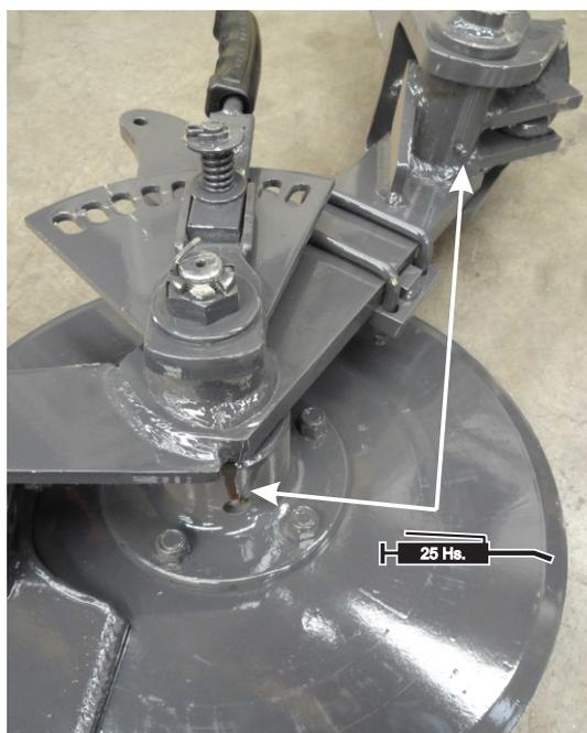
Figura 12: Buje de disco fertilizante
