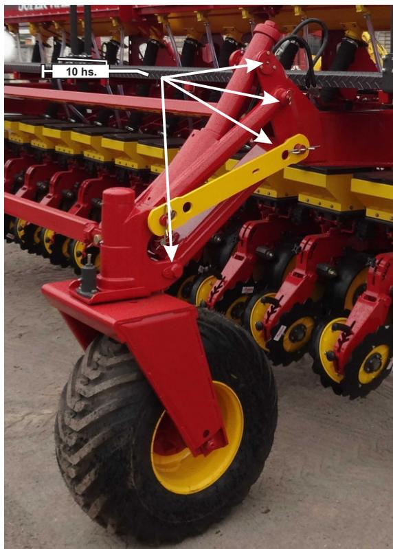
Figura 5: Paralelogramos levante
