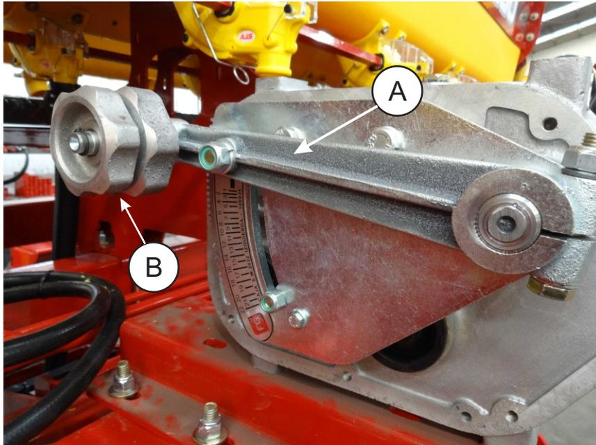
Para regular la dosificación de siembra, deberá mover la palanca: **A**, y ajustar con la perilla **B** en el punto deseado.
